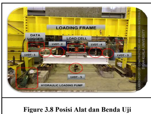
Figure 3.8 Posisi Alat dan Benda Uji
